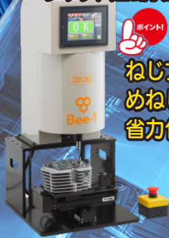
タップ穴自動検査装置 Bee-1
